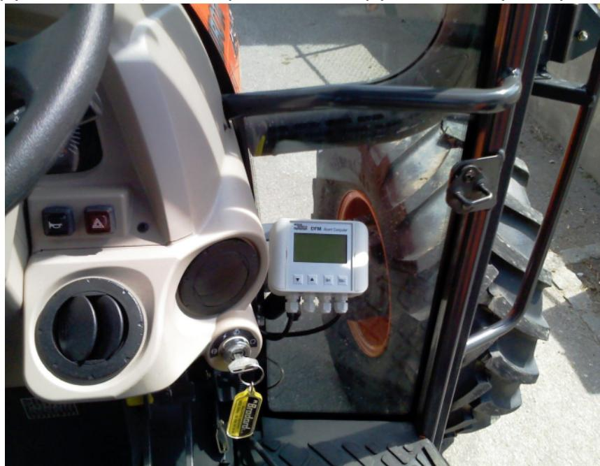
После того, как вы установили и присоединили счетчик к топливной системе, следует подключить его к DFM-BC в кабине (если вы приобрели полный комплект). Протяните хорошо изолированный и устойчивый к дизельному топливу кабель от счетчика к кабине. Длина штатного кабеля 7.5 метров, этого достаточно даже для комбайна с задним расположением двигателя. Подача питания к DFM-BC обычно
